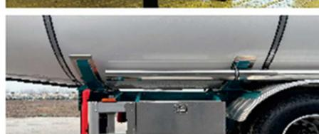
◆1. Avec une section transversale elliptique, le corps du réservoir est plus court pour un même volume, ce qui résulte en un poids à vide plus léger.
